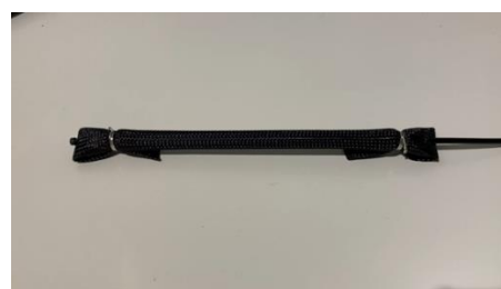
図 1: マッキベン型空気圧人工筋
